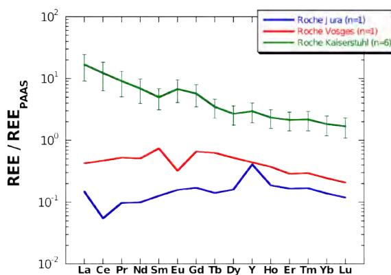
Fig. 52 : Spectres de TR ( $\pm$  écart type) du calcaire du site du massif du Jura (site Cussey-sur-Lison), du granite des Vosges (site du Strengbach) et des carbonatites du Kaiserstuhl. Les spectres de TR des trois sites sont clairement différents. Notamment les carbonatites ont des teneurs en TR très élevées et des spectres fortement enrichis en TR légères.
