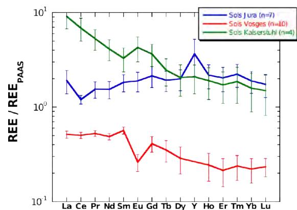
Fig. 53 : Spectres moyens de TR ( $\pm$  écart type) des sols du site du massif du Jura (site Cussey-sur-Lison sur calcaire), du massif des Vosges (site du Strengbach sur granite) et du Kaiserstuhl (carbonatates). La comparaison avec les spectres des roches correspondantes (Fig. 52) montre que les sols ont en grande partie hérité le spectre de la roche mère. Uniquement les sols du massif des Vosges montrent une évolution significative des spectres de TR par rapport à celui de leur roche mère.
