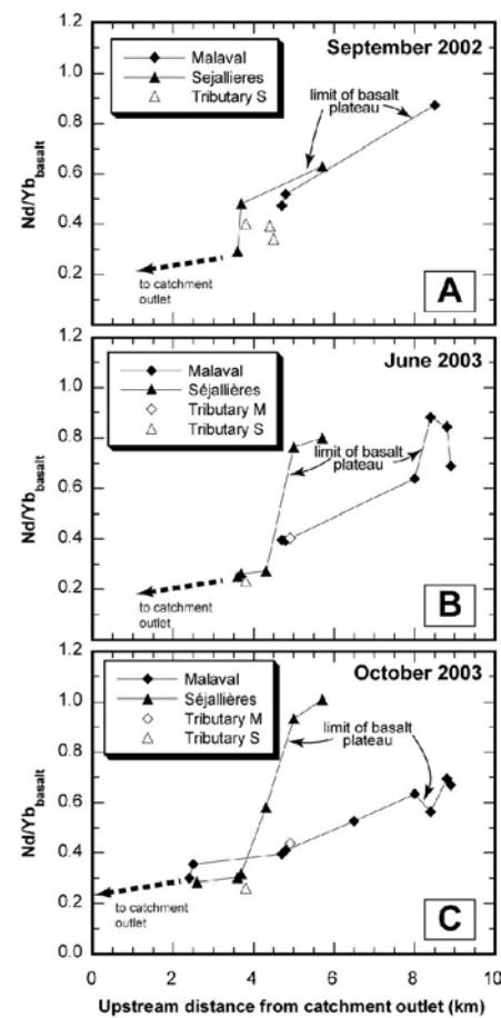
Fig. 46 : Évolution des rapports Nd/Yb dans l'eau filtrée à 0.45 µm des ruisseaux Malaval et Séjallières. Le rapport Nd/Yb permet, comme le rapport La/Yb, de quantifier un fractionnement entre TR légères et TR lourdes. Il montre que l'appauvrissement en TR légères s'accentue de l'amont vers l'aval (Fig. 4 de Steinmann et Stille, 2008).
