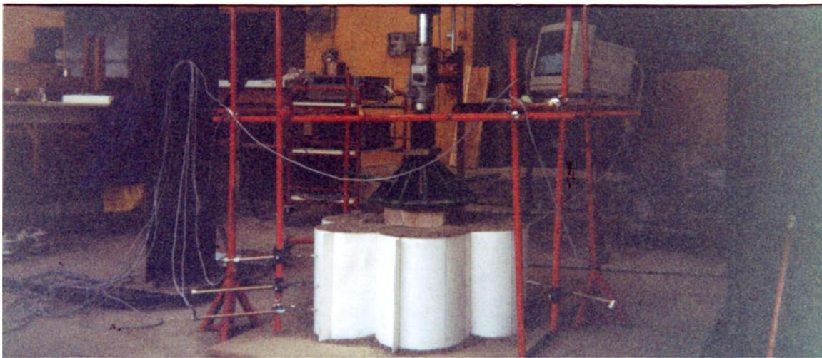
On réalise la mesure de l'enfoncement de la plaque d'appui supérieure par un capteur de déplacement. Des mesures de déformation apparaissant à la périphérie sont réalisées en cours d'écrasement afin de déterminer une tension moyenne dans le géotextile.
