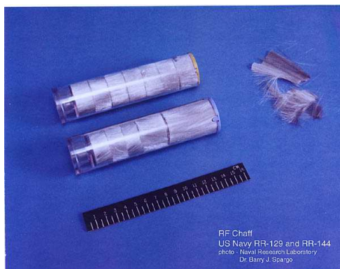
FIG. 3.8 – Leurres électromagnétiques (chaff) avec leurs douilles.
