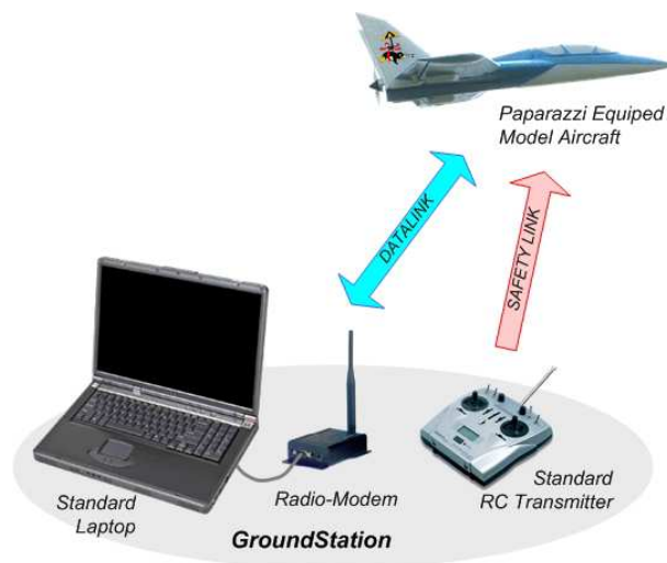
FIG. A.1 – Les différents composants du système Paparazzi .
