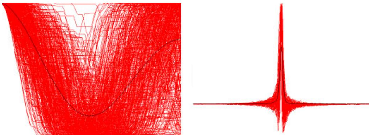
**Figure 2.15** : Somme des FID de toutes les molécules de l'échantillon (à gauche) et spectre RMN après transformée de Fourier (à droite) dans le cas où  $\Delta\nu=100$  Hz.
