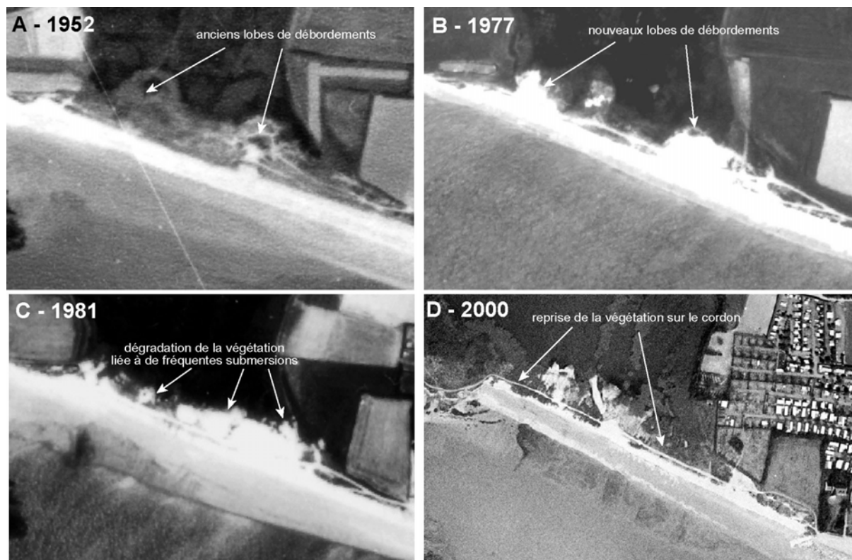
Figure 177 : Localisation des lobes de débordement et dégradation du cordon sableux de la Bédume (anse de Bétahon) liée aux fréquentes submersions marines, entre 1952 et 2000.
