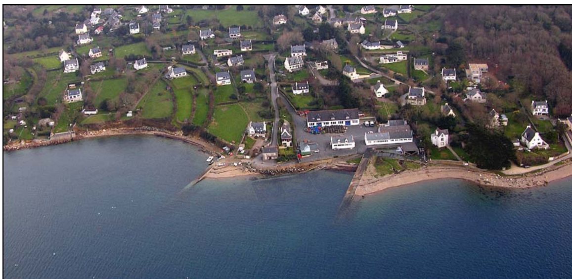
Photographie 26 : Cales de Keralliou sur les rives de l'Elorn, illustrant l'effet de blocage du transit sédimentaire par les ouvrages transversaux (cliché : Solen Le Berre, Louis Brigand, 22/02/05).
