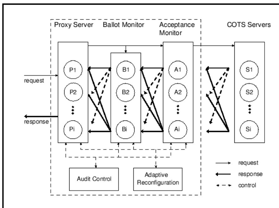
FIG. 1.6 – Schéma général de l'architecture de SITAR
