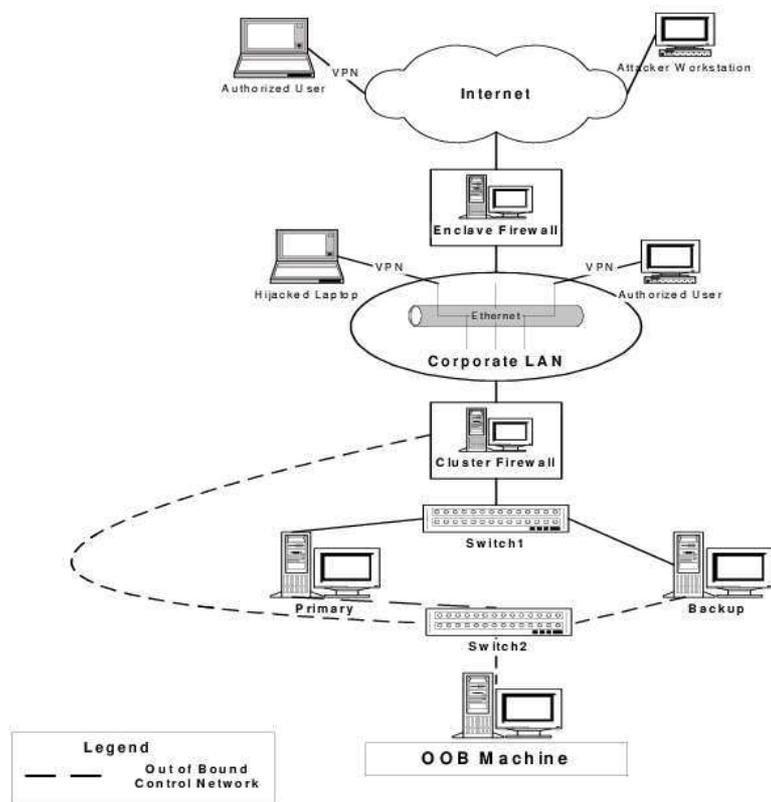
FIG. 1.5 – Schéma général de l'architecture de HACQIT
