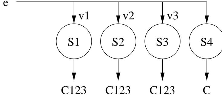
FIG. 2.3 – Exemple présentant un cas de détection d'intrusions valable dans le cadre de la programmation N-versions et de la diversification de COTS. Dans cet exemple,  $f = 3$ ,  $e$  est une entrée;  $v1$ ,  $v2$ ,  $v3$  des vulnérabilités exploitées;  $C*$  les différents comportements.
