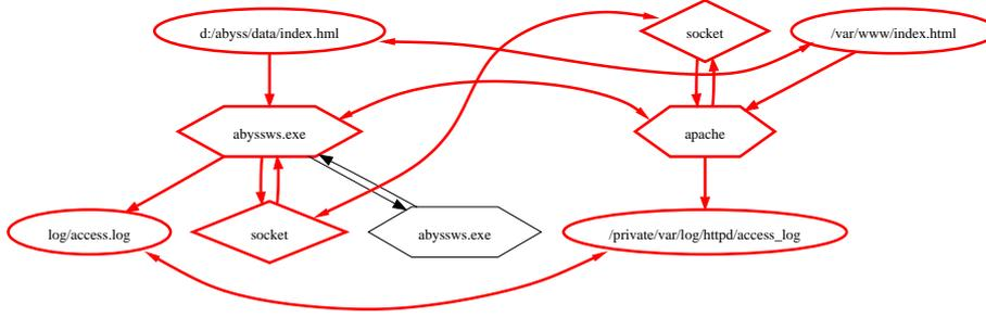
FIG. 2.7 – Exemple de mapping entre deux graphes de flux d’informations : mapping entraînant une similarité forte
