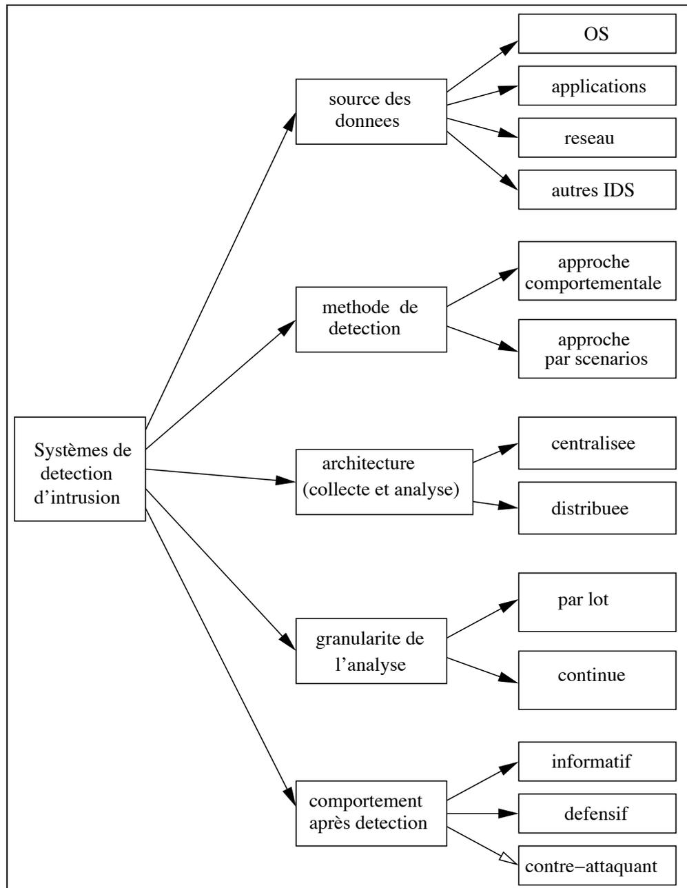
FIG. 2.1 – Une classification des systèmes de détection d'intrusions
