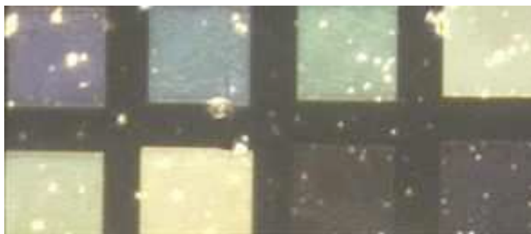
FIG. 3.6 – Image en champ sombre de 8 réseaux de nanofils d'or lithographiés. Les réseaux avec des couleurs différentes ont des résonances plasmons différentes. Cet échantillon n'est pas propre.
