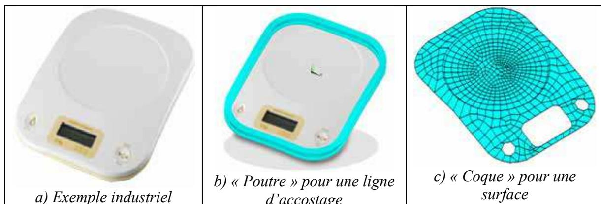
Figure 4.5 Modèle « poutre » ou modèle « coque »
