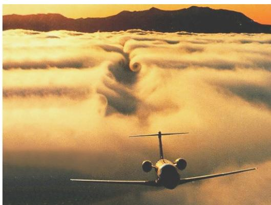
Turbulence générée derrière l'avion.
