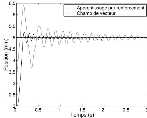
FIGURE 8.19 – Comparaison des deux méthodes de contrôle sur une tâche de positionnement avec la simulation de la surface. La position de consigne est représentée par une ligne pointillée en  $x_G = 5\text{mm}$ .
