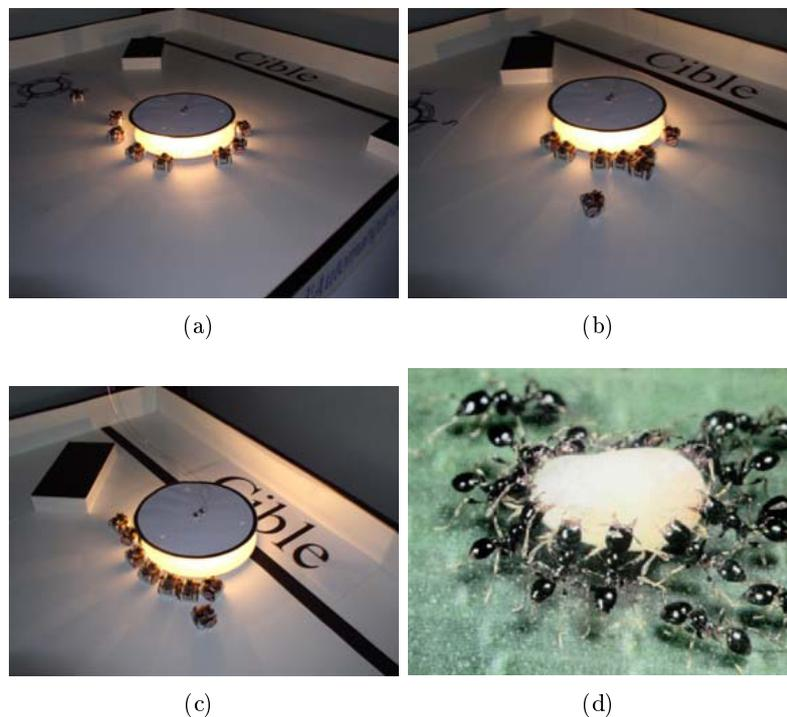
FIGURE 1.3 – Des minirobots ALICE ( $21 \times 19 \times 18mm$ ) [CES02] poussent un objet cylindrique d’une position initiale (a) vers la cible à atteindre (c) [Ado05]. Le déplacement de l’objet nécessite une quantité minimum de minirobots. d) Tâche coopérative de transport d’objets par un groupe de fourmis.
