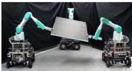
FIGURE 1.5 – Tâche nécessitant la coopération des robots [HHK<sup>+</sup>02].
