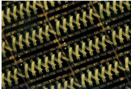
FIGURE 1.4 – Système distribué de micromanipulation « à contact » constitué de microactionneurs en polyimide dont l’effet thermique reproduit le mouvement des cils des organismes vivants [AOTF94].
