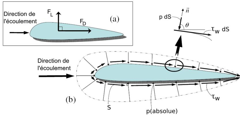
FIGURE 8.9 – Forces agissant sur un « corps à pointe » a) Résultantes des forces de « traînée »  $F_D$  et de « portance »  $F_L$  b) Forces de pression et tangentielles agissant sur une surface élémentaire.
