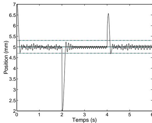
FIGURE 8.18 – Résultats du positionnement avec la simulation de la surface et la méthode par apprentissage par renforcement lorsque les politiques gloutonnes sont suivies. Perturbations en 0s ( $x_{ini} = 7\text{mm}$ ), 2s ( $x_{ini} = 2\text{mm}$ ) et 4s ( $x_{ini} = 4\text{mm}$ ). La position de consigne est représentée par une ligne pointillée en  $x_G = 5\text{mm}$ . Les deux lignes pointillées délimitent la marge définie pour la fonction de récompense.
