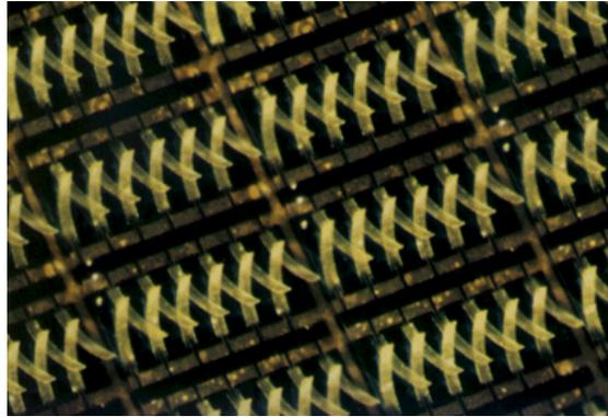
FIGURE 8.3 – Système distribué de micromanipulation « à contact » constitué de microactionneurs en polyimide dont l'effet thermique reproduit le mouvement des cils dans les organismes vivants [AOTF94].
