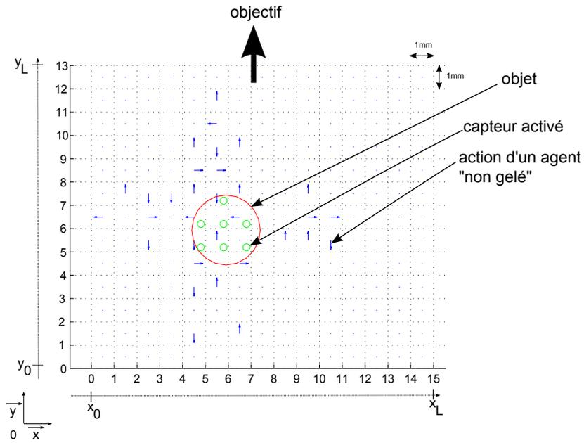
FIGURE 8.24 – Description de la tâche de convoyage (illustration issue de l’interface graphique de la simulation de notre modèle).
