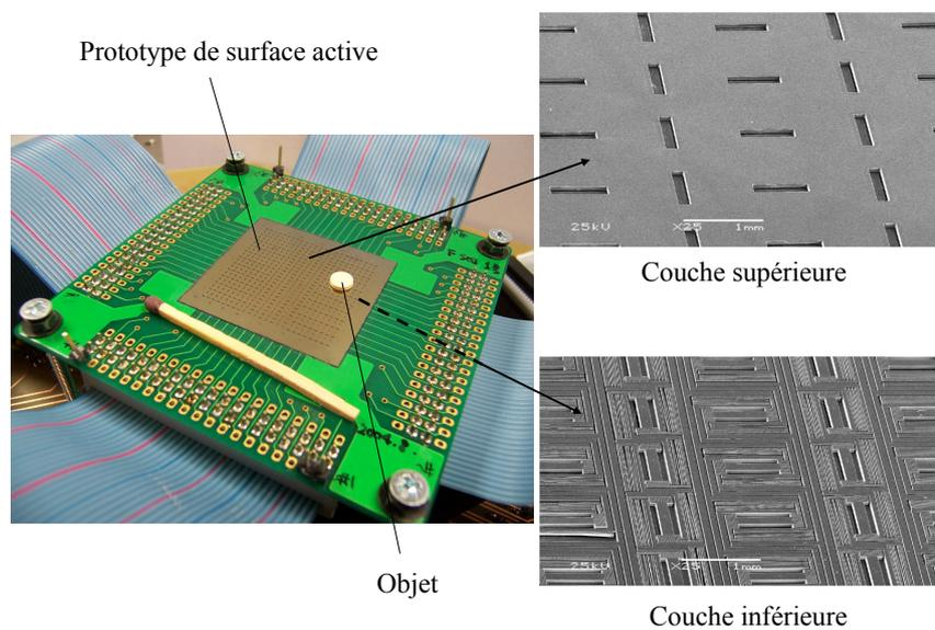
FIGURE 8.8 – Photo de la surface active pneumatique ainsi que les images MEB de la couche supérieure et de la couche inférieure.
