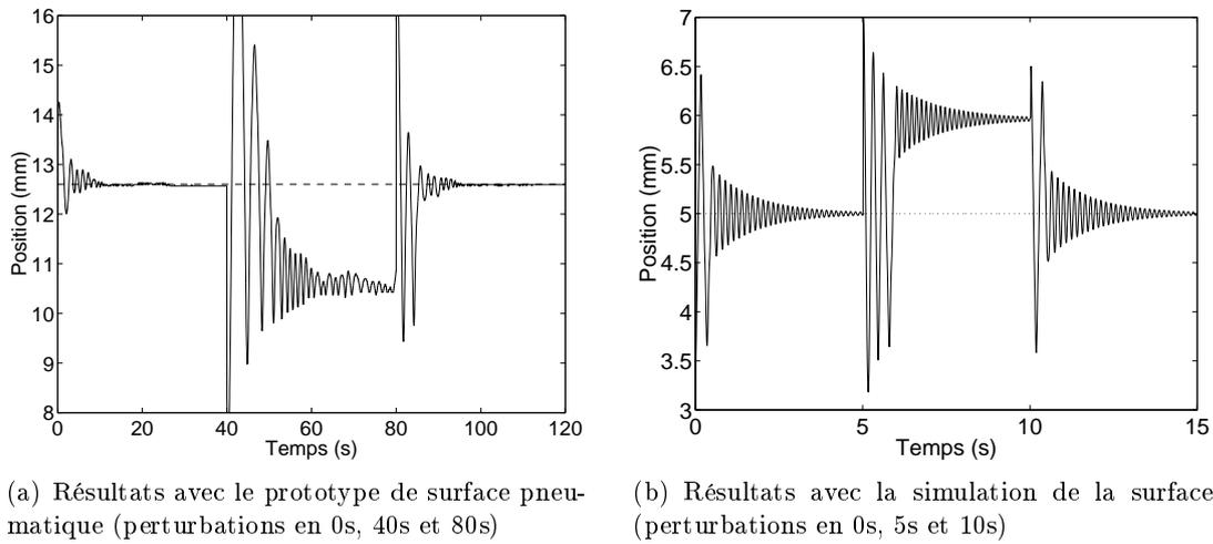
FIGURE 8.17 – Résultats du positionnement (après perturbations) avec la méthode par champ de vecteur programmable. La position de consigne est représentée par une ligne pointillée en a)  $x_G = 12,7\text{mm}$  b)  $x_G = 5\text{mm}$ .
