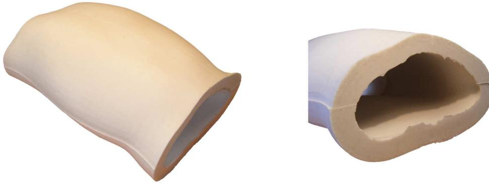
**Figure 3.22:** *Prototype de validation coulé avec le caoutchouc silicone SICOVOSS NL de Soloplast*
