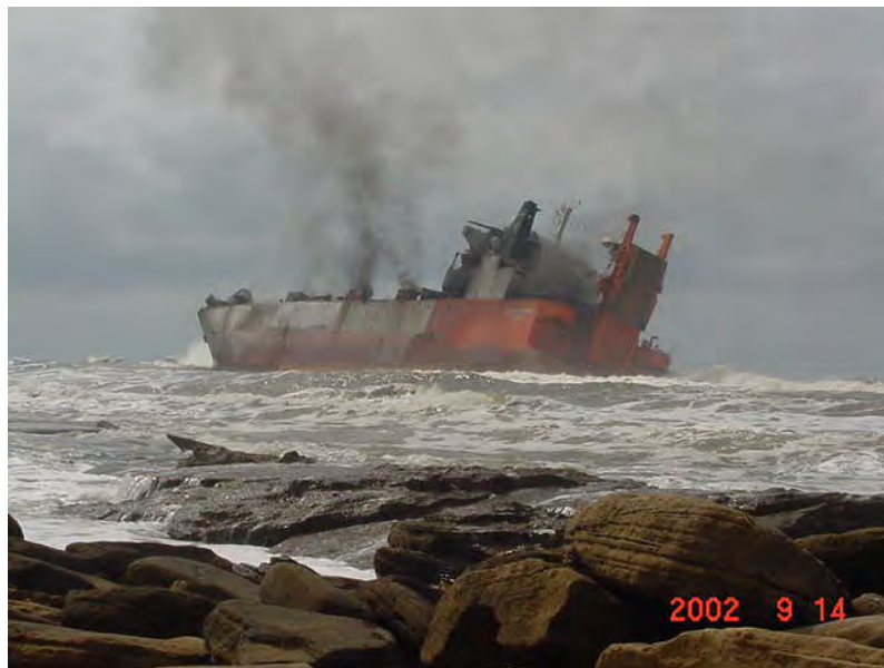
Photo 61 : L'incendie du Jolly Rubino lié à l'inflammabilité des substances toxiques
