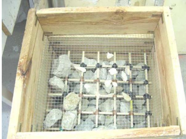
FIG. 3.11 – Tamisage à sec de l'échantillon de sol.
