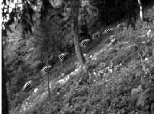
FIG. 6.7 – Exemple de film de la trajectoire des blocs obtenus lors des essais en grandeur réelle.
