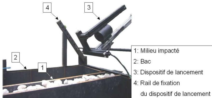
FIG. 3.2 – Dispositif expérimental.
