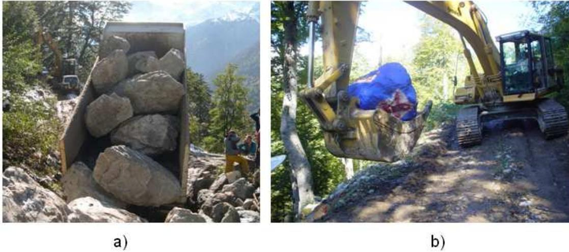
FIG. 6.5 – a) Blocs utilisés lors des essais en grandeur réelle ; b) Lâcher des blocs à l'aide d'un tracto-pelle.
