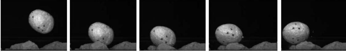
FIG. 3.18 – Zoom d’images brutes issues du film à la caméra rapide d’un essai. Lors de l’impact, l’impactant est caché par les pierres de l’éboulis. Le mouvement des points marqués sur l’impactant met en évidence la rotation de l’impactant hors du plan d’incidence.
