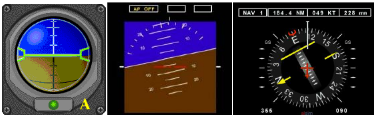
Figure 24 : Différents types de symbologies synthétiques utilisées pour l'indicateur d'horizon artificiel.
