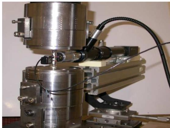
Figure 45 : Dispositif de microscopie in-situ [El Bartali 2007].
