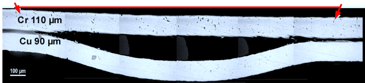
Figure 6.15 : Vue en coupe de l'échantillon LALP0602 crcu2-2s25. Le tir est porté côté chrome. Diamètre de la tache focale de 2 mm, matérialisée par un trait rouge. Flux incident 81 \text{ GW/cm}^2 . La fracture est quasi adhésive.
