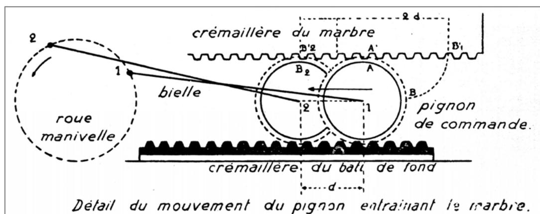
Déplacement du marbre entraîné par le pignon qui exécute un mouvement de va-et-vient
