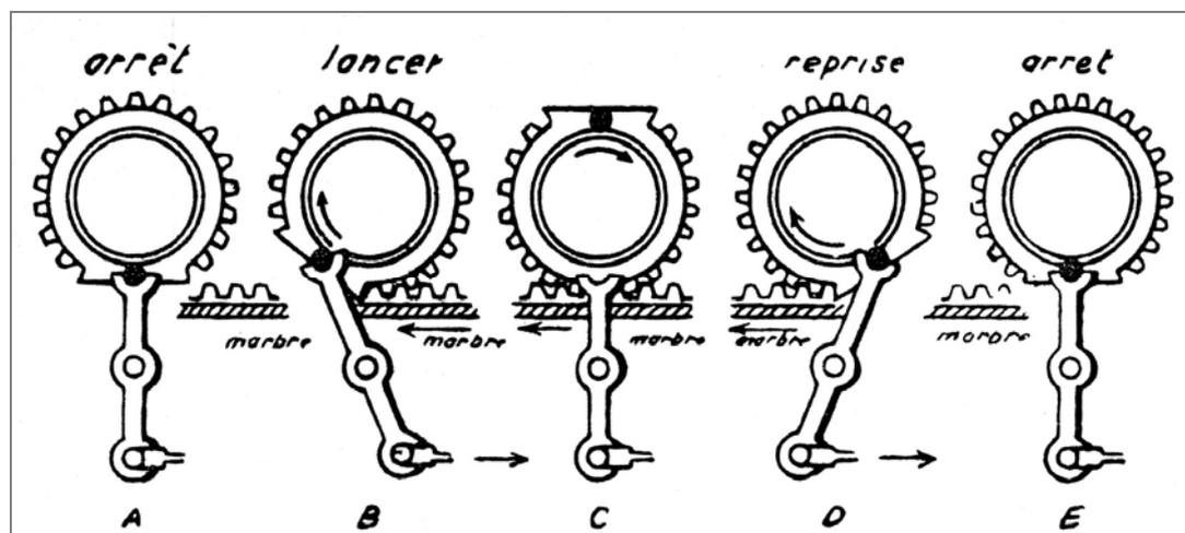
Schéma de fonctionnement de la fourchette de temps d'arrêt : la fourchette
