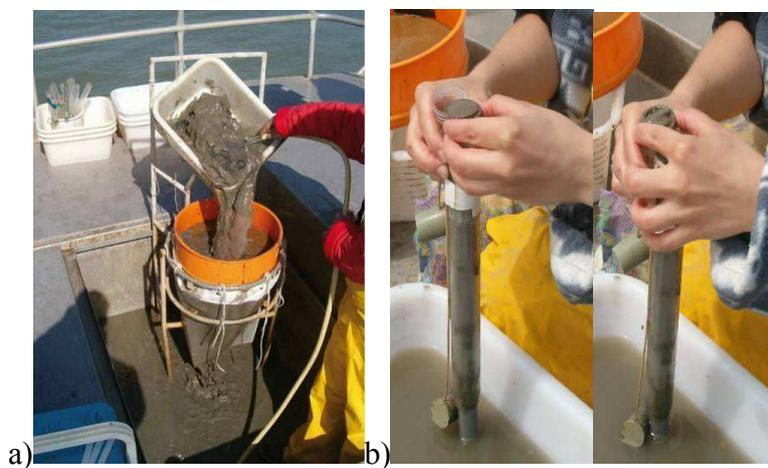
Figure II 9 : a) Tamisage du sédiment à bord du bateau pour récupérer la macrofaune. Tamis à maille carrée de 500 µm. b) Découpage des carottes par tranche de 1 cm.
