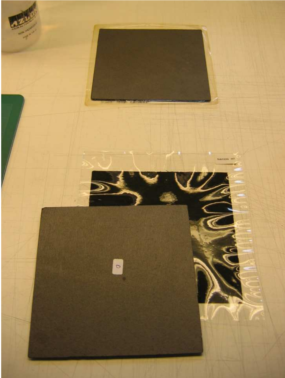
Schéma 4 : dépôt d'une « encre » contenant du platine (électrodes) de part et d'autre de la membrane Nafion ® pour constituer une cellule électrode-membrane-électrode.
