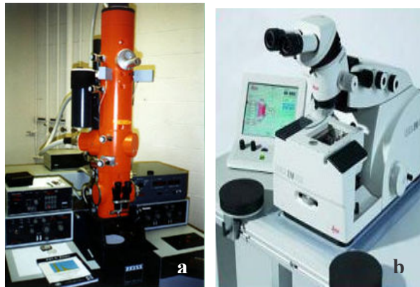
Figure 1.14. Microscopie électronique en transmission JEOL JEM 1230 (a) et Ultracryomicrotome LEICA EM FC6 (b).
