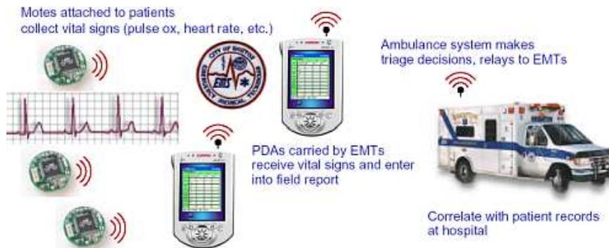
Figure I-10 : Principe du système VITAL DUST.
