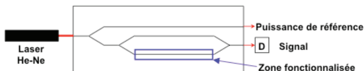
Figure 1. 11 : Schéma de principe d'un interféromètre de Mach-Zehnder intégré.
