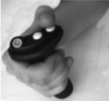
Dans la main dominante, on utilise un capteur de position 3D. Il s'agit ici d'un capteur acoustique *FreeD* de *Pegasus Technologies* (système à ultrasons), anciennement appelé *Owl*. Il possède trois degrés de liberté, qui donnent la position du capteur dans l'espace. On l'utilise couramment en raison de son prix peu élevé (résolution de 100 dpi, pour une fréquence de 50 Hz).
