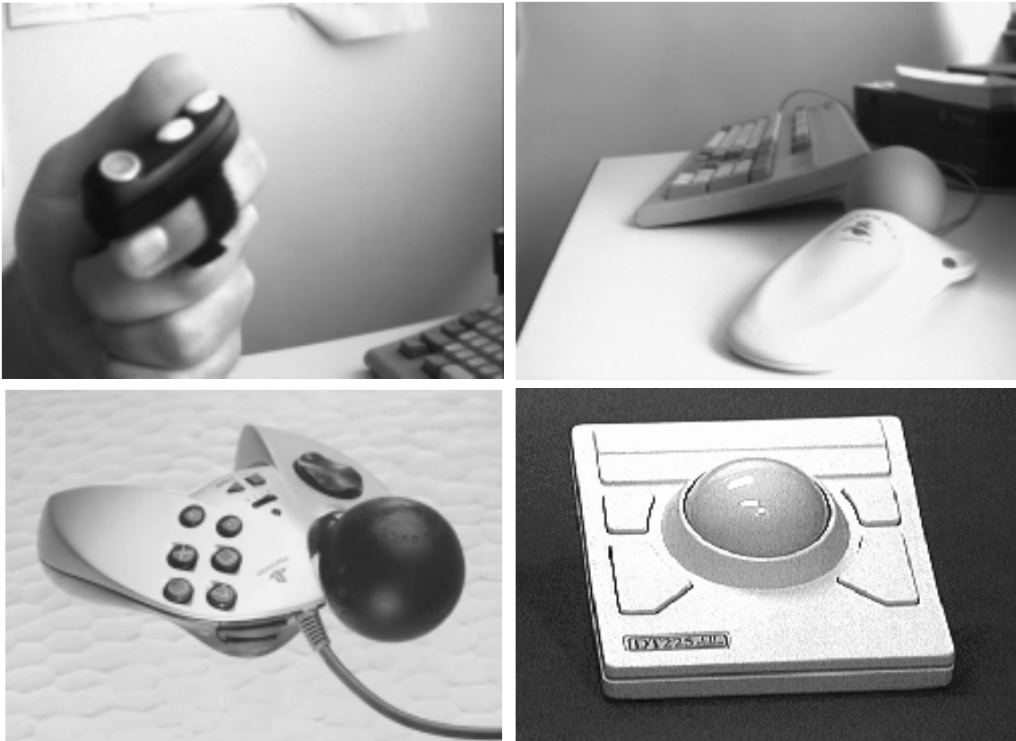
Figure 1.10 en haut : capteur 3D (FreeD de Pegasus), trackball 3D (Spaceball 3003) en bas : manette de jeux à 6 degrés de liberté (Spaceorb), trackball 2D classique
