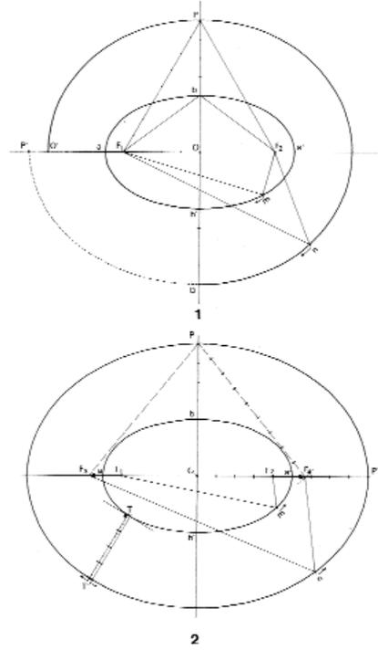
Fig. 375 b. « Problème du tracé des ellipses multiples: écartement défavorable des ellipses à foyer commun ( $Pb > Q'a$ ); réalisation d'un contour extérieur parallèle à celui de l'arène », d'après J.-Cl. GOLVIN, 1987.
