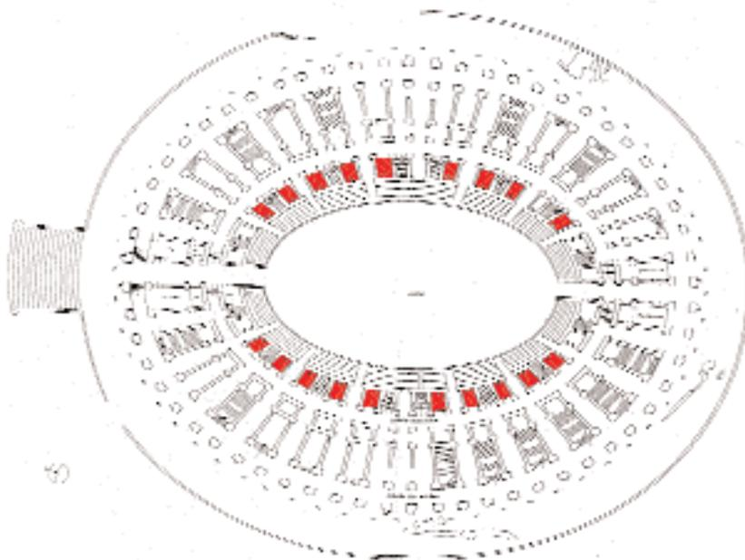
**Fig. 511.** *Projet d'installation de 23 sanitaires (en rouge) au sein de l'amphithéâtre d'Arles. Plan d'A.-Ch. PERROT, juin 1998. (Services techniques de la ville d'Arles.)*
