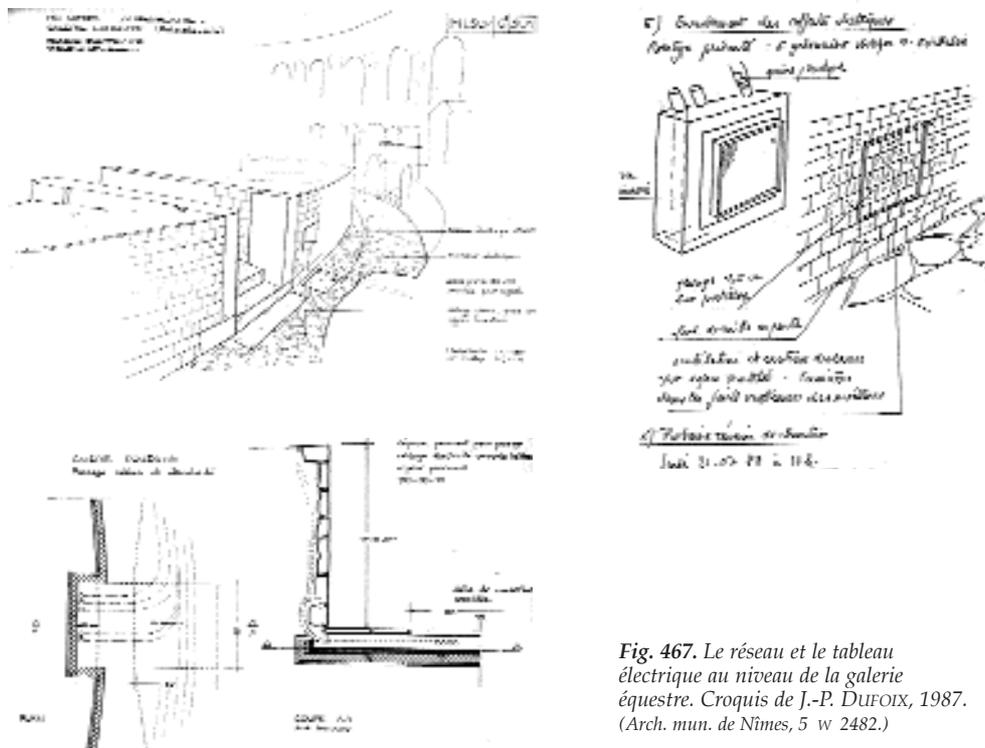
Fig. 467. Le réseau et le tableau électrique au niveau de la galerie équestre. Croquis de J.-P. Duroix, 1987.
