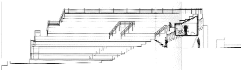
Fig. 441. « Arles– Bouches-du-Rhône. Étude préalable de la restauration de la *cavea*, de l'orchestre et intégration de la régie de projection ». a. Cabine de projection en position haute; b. Cabine de projection en position basse. Coupes longitudinales d'A.-Ch. PERROT, mars 1998. (*Service technique d'Arles*.)
