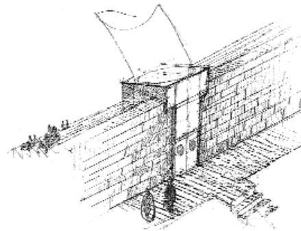
Fig. 455 c. « Esquisse d'appui de la couverture mobile »: structure métallique des caissons servant d'appui aux boudins de toile. (Arch. mun. de Nîmes, 5 w 2489.)
