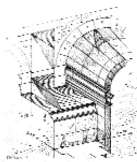
Fig. 342a. Section du corridor annulaire du second niveau de l'amphithéâtre d'Arles. (G. Lugli, op. cit., dessin de Durm.)
