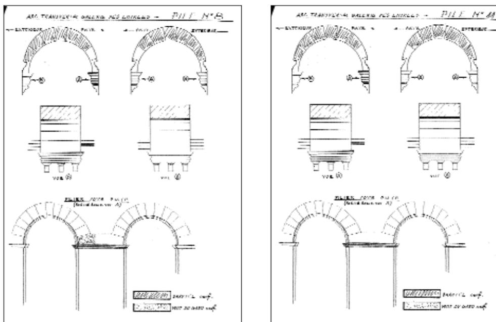
Fig. 335. « Gard. Nîmes. Arènes. Restauration des arcs doubleaux de la galerie des entrées. Cahier des croquis localisant les reprises en pierre (suivant chap. II A du C.C.T.P.). Travées n° 08, 11, 12, 13, 14 et 41. » Dessin de J.-P. Dufoix, 1991. Exemple des piles n° 8 et 11. (Arch. DRAC - Languedoc-Roussillon.)
