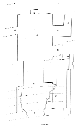
Fig. 305. Amphithéâtre de Nîmes, « Grande entrée du côté du levant ». Dessin d'A. PELET. (MARG, 1838.) En A, la chambre d'environ 16 m 2 ; en B, un passage de 2 m de large, couvert d'une voûte rampante et fermé en D par un mur moderne ; en K, une niche de 80 cm de large, abritant côté ouest un puits ; en E, une porte ouverte sur les grandes entrées ; en F, une porte communiquant avec un « petit ciel-ouvert » en G.
