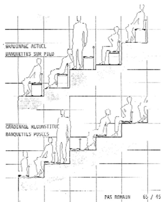
Fig. 499. Proposition de remplacement des banquettes sur pied des « premières » de l'amphithéâtre de Nîmes par des bancs adaptés au profil antique. Croquis de N. MICHELIN et F. GEIPEL, octobre 1986. (Arch. mun. de Nîmes, 5 w 2494.)
