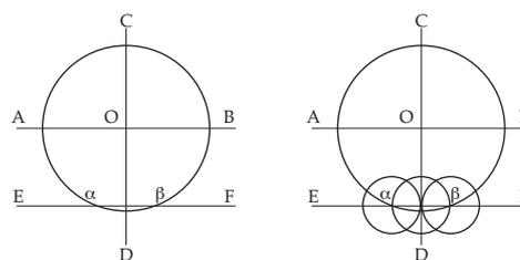
Fig. 348. Le tracé théorique du théâtre antique selon D.B. SMALL, 1983. Sur la ligne (E, F) correspondant à la *scænæ frons*, les deux intersections  $\alpha$  et  $\beta$  sur le cercle de base dessinant l'*orchestra* déterminent l'écartement de la *valva regia* ainsi que le centre de deux cercles tangents de même diamètre destinés à marquer de chaque côté la disposition de chacune des *valvæ hospitales*.
