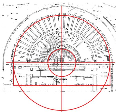
Fig. 358. Application de deux cercles sur le pourtour dessiné en plan de l'*orchestra* et de la *cavea* des théâtres d'Arles, d'Orange et de Vaison et d'un rectangle correspondant au complexe scénique, à partir des relevés d'A. Chauvel (1942), J. Formigé (1933) et l'abbé J. Sautel (1925).
