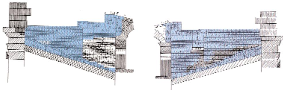
**Fig. 299.** « Coupe[s] en long sur la montée d'escalier conduisant de la galerie d'entre-sol à celle du 1<sup>er</sup> étage correspondante à l'arc N° 15 ». Relevés de A. VÉRAN, carnet d'attachement, 1894-1895. En bleu, les travaux de reconstruction et de nivellement effectués. (Arch. dép. des Bouches-du-Rhône, 18 F 5/5.)
