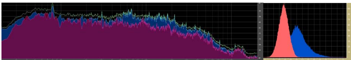
Fig.5 : Analyse fréquentielle (moyenne ou niveau équivalent par fréquence) du fragment originel (en vert), du premier plan (bleu) et du fond sonore (rouge).
