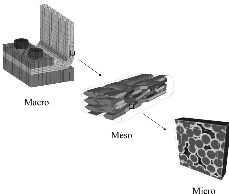
FIGURE 1 – Schématisation des différentes échelles d'une structure composite.
