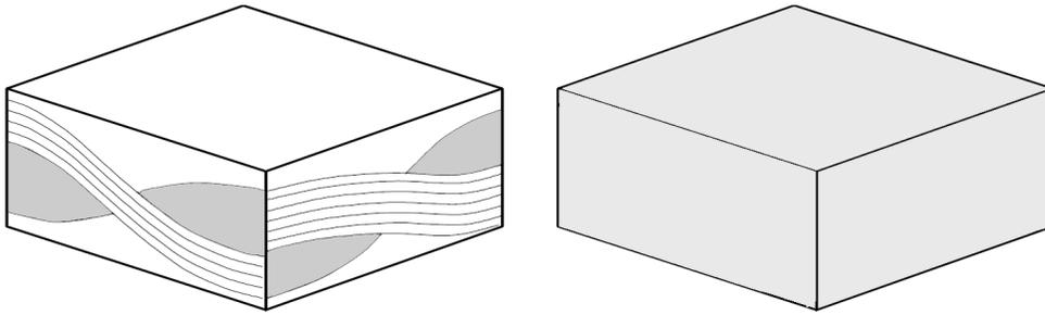
FIGURE 2.1 – Concept de matériau homogène équivalent
