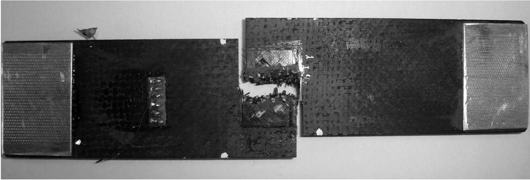
FIGURE 8.5 – Faciès de rupture de l'éprouvette à double entaille décalées à  $0^\circ$  pour le matériau 2.5D-C/SiC.
