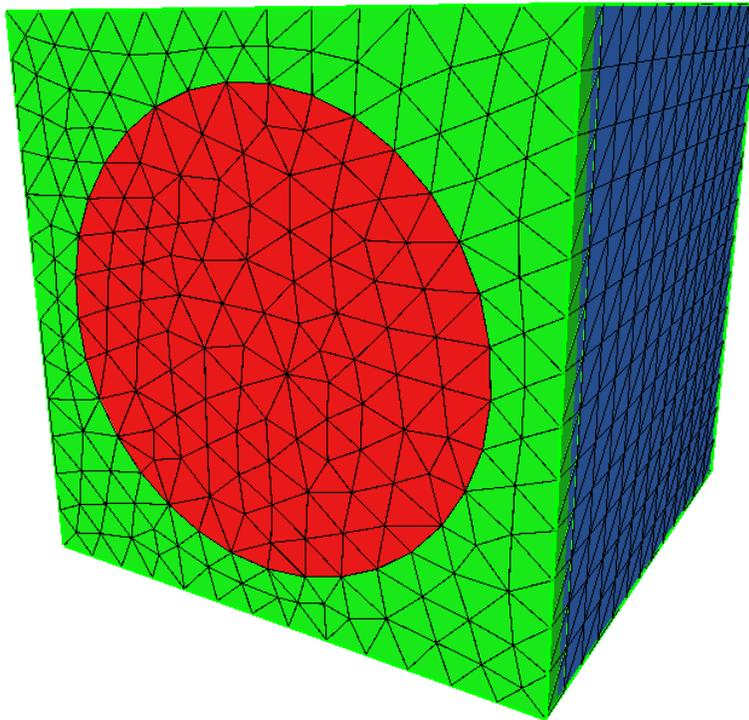
FIGURE 6.1 – Maillage de la cellule fibre/matrice.
