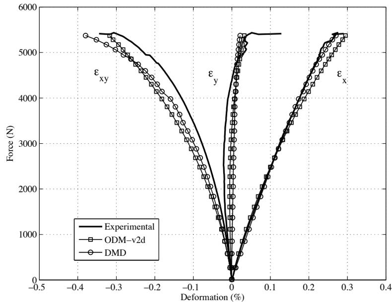
FIGURE 8.3 – Comparaison des courbes force/déformation expérimentales et simulées avec les modèles ODM et DMD pour un essai traction sur éprouvette à double entaille décalées à  $0^\circ$  pour le matériau 2.5D-C/SiC.
