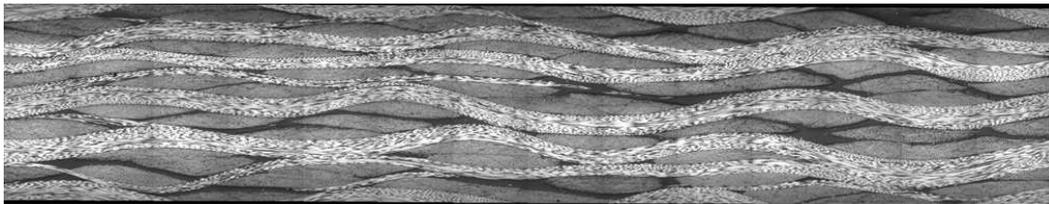
FIGURE 1.4 – Microstructure du 2.5D-C/époxy (épaisseur 2.5 mm).
