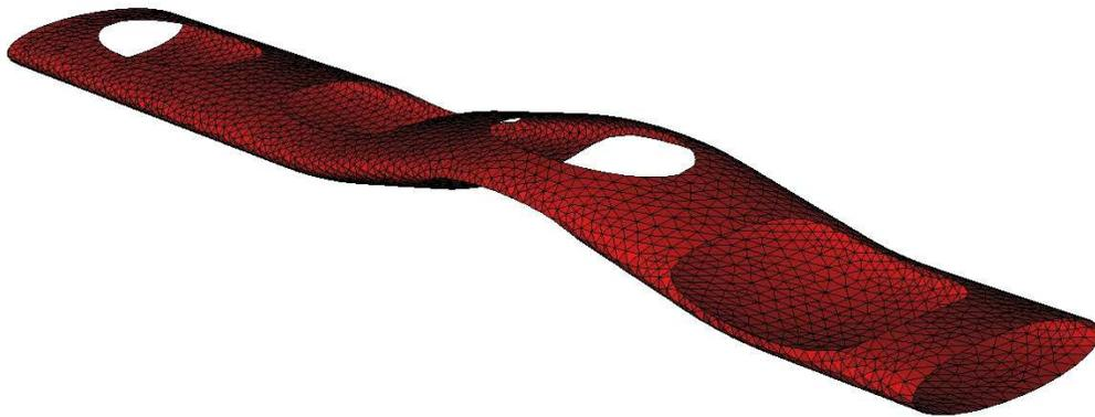
FIGURE 4.22 – Maillage surfacique corrigé d’une gaine de matrice.
