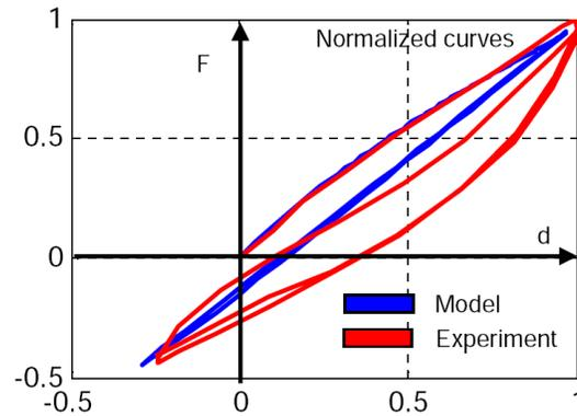
FIGURE 8.9 – Réponses expérimentales et simulées par le modèle ODM de l'essai « torsion » pour le matériau C/MAC. D'après [MAR 08].
