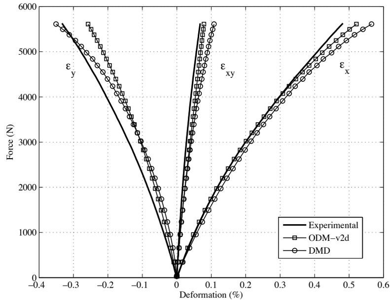
FIGURE 8.6 – Comparaison des courbes force/déformation expérimentales et simulées avec les modèles ODM et DMD pour un essai traction sur éprouvette à double entaille décalées à  $45^\circ$  pour le matériau 2.5D-C/SiC.
