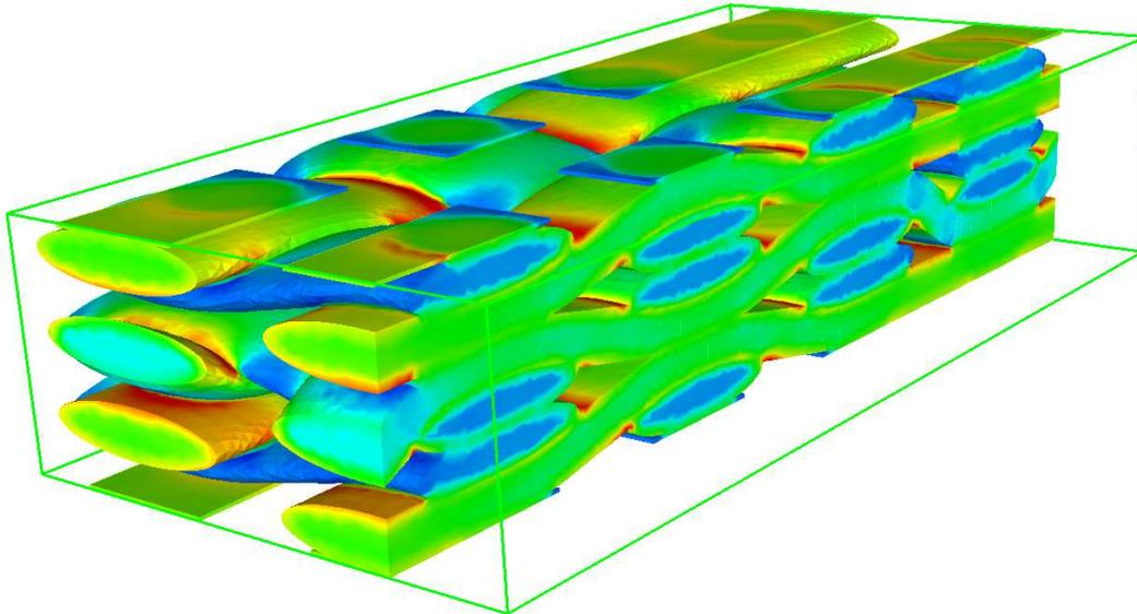
FIGURE 4.26 – Résultat d'un calcul EF sur une cellule élémentaire d'un matériau composite tissé générée avec GENTEX/GENMESH : contrainte  $\sigma_{11}$  pour un chargement périodique  $\bar{\epsilon} = \epsilon_{11}$ .
