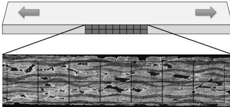
FIGURE 1.15 – Suivi *in-situ* de l'endommagement par microscopie optique
