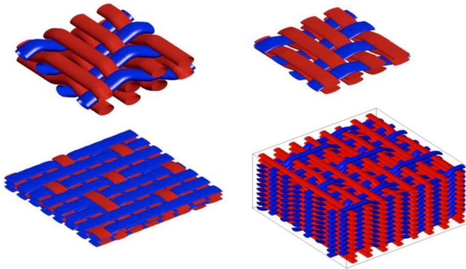
FIGURE 4.4 – Exemples de cellules tissées générées par GENTEX
