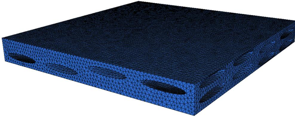
FIGURE 4.16 – Maillage EF volumique d'une matrice type CMO
