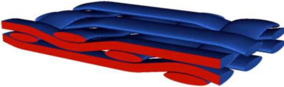
FIGURE 4.13 – Modèle volumique d'un renfort tissé
