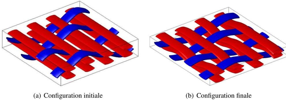
FIGURE 4.3 – Géométrie initiale et finale d'une cellule tissée.
