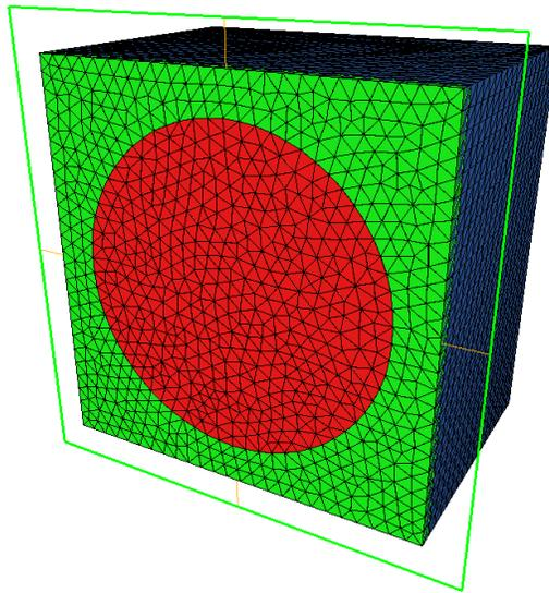
FIGURE 5.4 – Maillage de la cellule fibre/matrice
