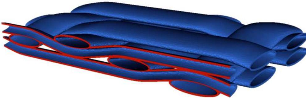
FIGURE 4.17 – Modèle volumique d'une matrice type CMC
