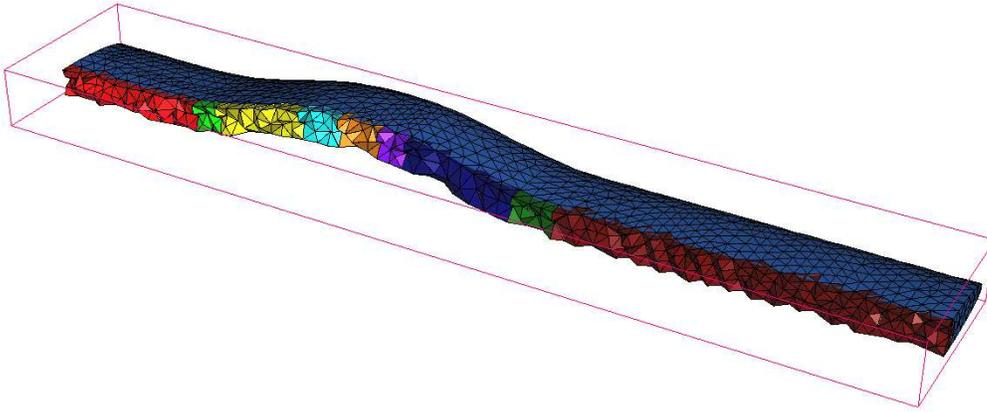
FIGURE 4.12 – Orientation du matériau au sein d'un fil
