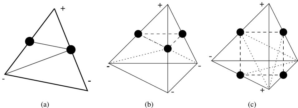
FIGURE 5.3 – Subdivision d'un triangle et d'un tétraèdre.
