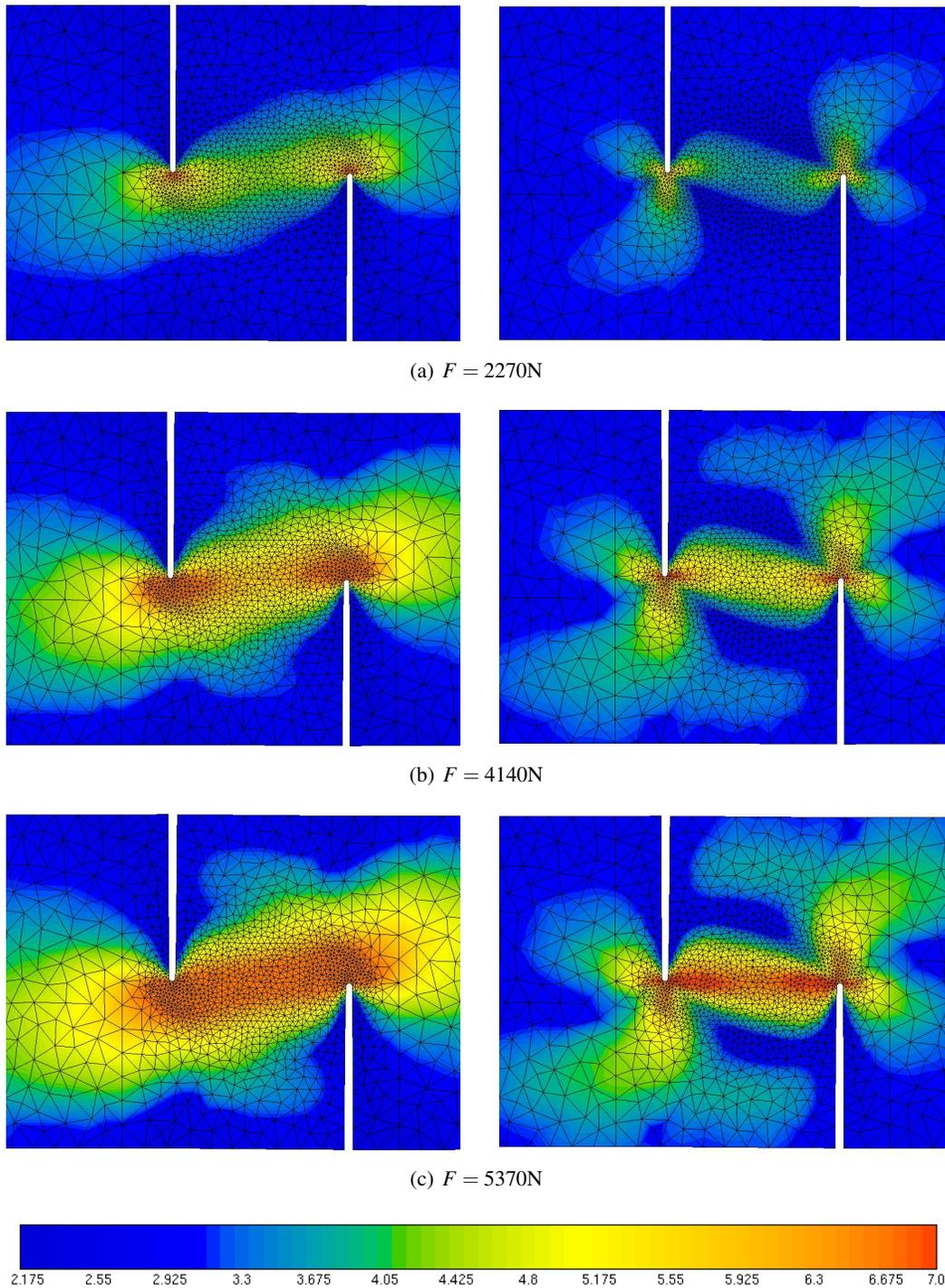
FIGURE 8.4 – Evolution des densités de fissuration matricielle interfil (en  $\text{mm}^{-1}$ ) dans les directions 1 (gauche) et 2 (droite) dans la zone centrale de l'éprouvette à double entaille décalées à  $0^\circ$  pour le matériau 2.5D-C/SiC.
