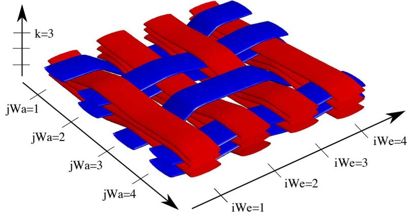
FIGURE 4.1 – Description de la séquence de tissage
