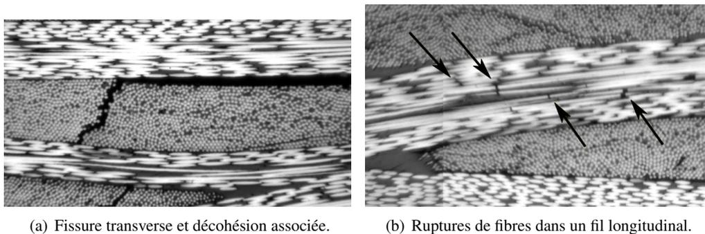
FIGURE 1.23 – Mécanismes d’endommagement du 2.5D-C/époxy
