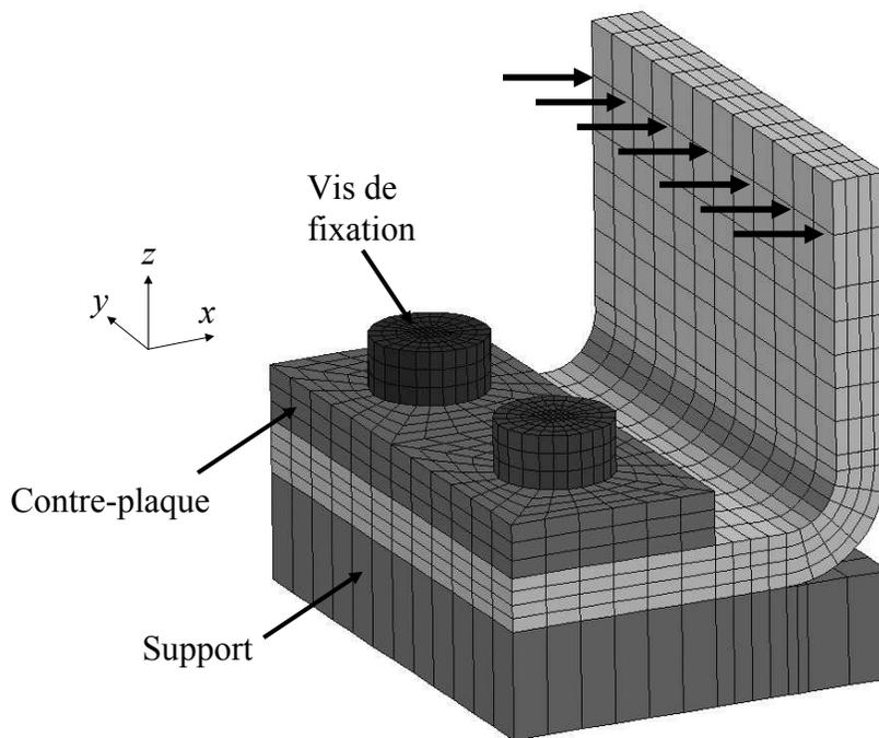
FIGURE 8.12 – Maillage EF et conditions limites du cas test « cornière ».
