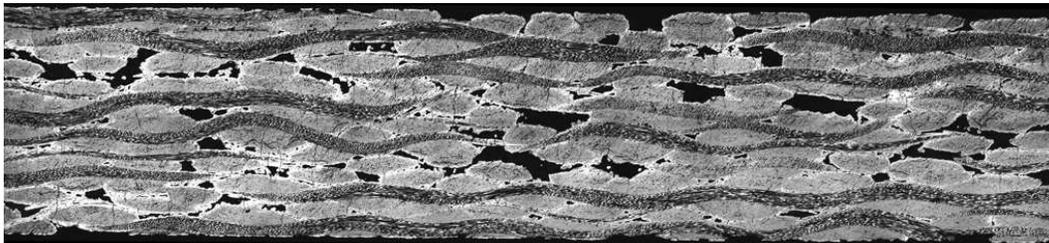
FIGURE 1.1 – Microstructure du composite 2.5D-C/SiC (épaisseur 4 mm).
