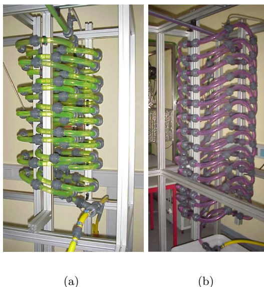
FIG. 3.3: Photos montrant les deux serpentins mélangeur-réacteur. 3.3(a) Serpentin hélicoïdal et 3.3(b) serpentin à trajectoires chaotiques.
