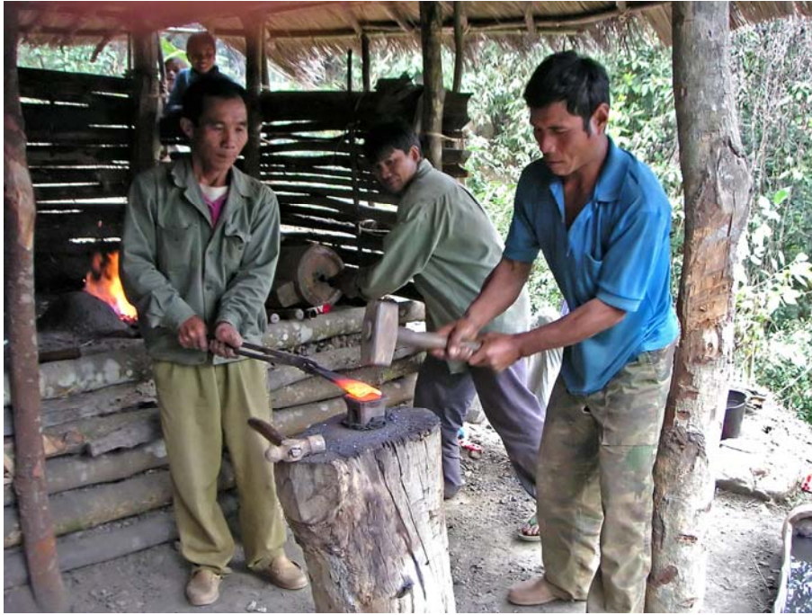
Photo 49 : Façonnage d'une machette à la forge villageoise (Tongpi, 12/2003)
