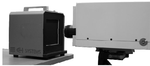
Figure 3.12 : caméra infrarouge (à droite) face au corps noir (à gauche)
