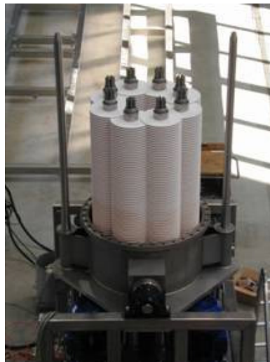
Figure 1.6 Module MSD industriel avec huit arbres parallèles et les disques membranaires de 31 cm de diamètre (Westfalia Separator)
