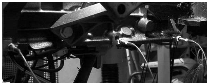
FIG. F.3 – Capteurs n°19,20 et 21 sur la jupe coté turbo
