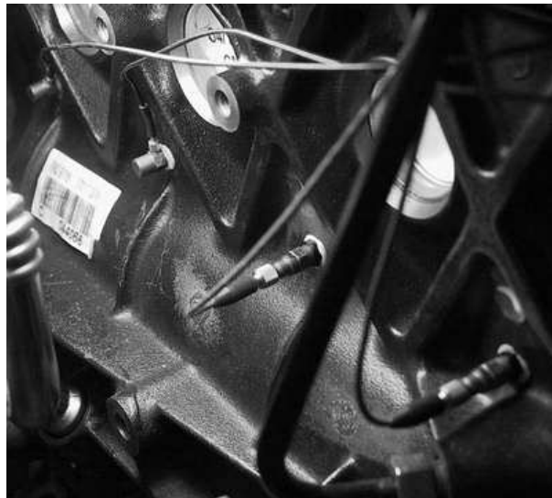
FIG. F.5 – Capteurs n°25 à 28 en face des fûts coté poussée (face turbo)
