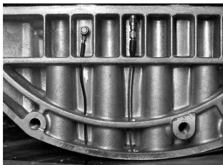
FIG. F.2 – A gauche capteurs n°5 et 6 (palier n°1 sur y et z ) à droite capteur n°24 sur la jupe
