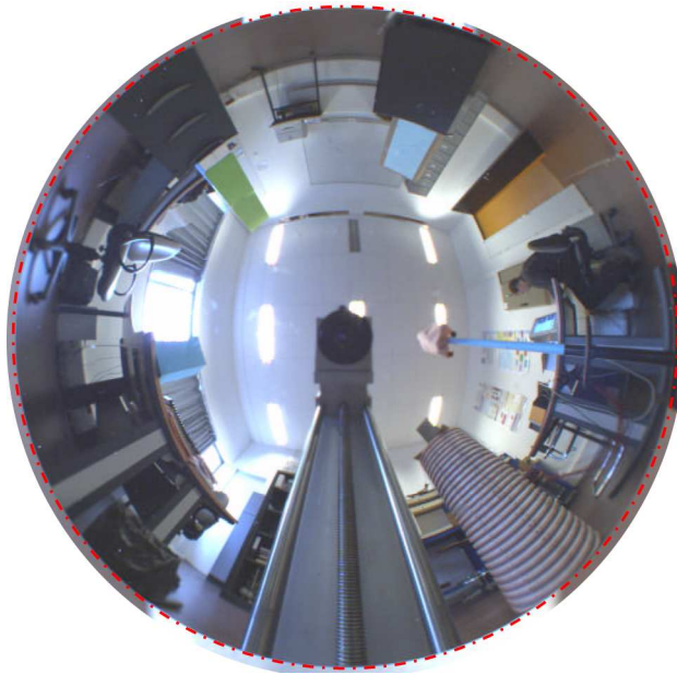
FIG. 2.4 – Illustration du processus de réglage du point de vue unique pour un capteur hypercatadioptrique, d'après la méthode de Zivkovic & Booij. Le cercle en pointillé rouge correspond à la projection théorique de la bordure extérieure du miroir lorsque l'assemblage caméra-miroir respecte la contrainte de point de vue unique. L'objectif est alors de régler mécaniquement le miroir de sorte à faire coïncider la bordure extérieure du miroir réellement observée avec celle pré-estimée.
