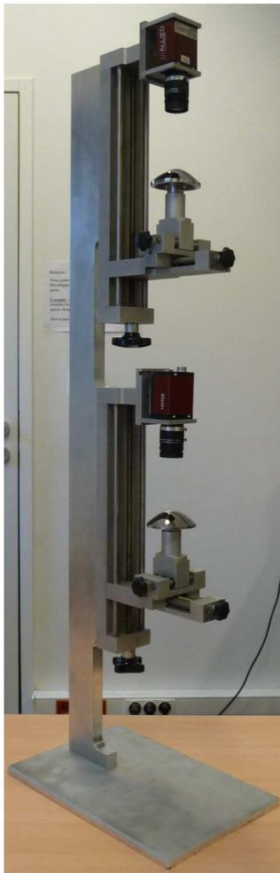
(a) Photo du dispositif de stéréovision omnidirectionnelle
