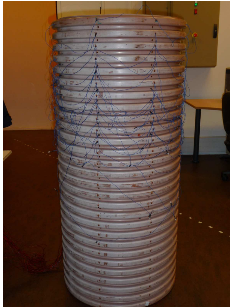
FIG. 2.15 – Photo de la mire d'étalonnage
