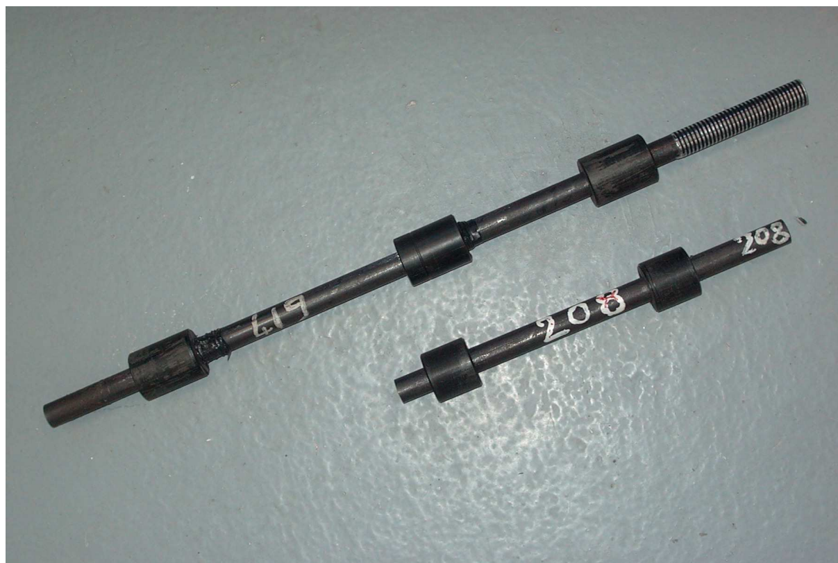
FIG. C.2 – Banc Marval - Photographies des impacteurs utilisés.
