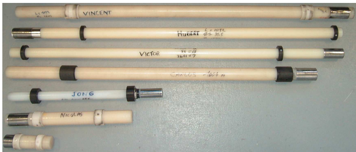
FIG. C.1 – Banc Nylon - Photographies des impacteurs utilisés.
