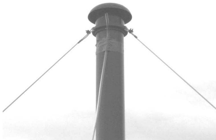
**Photo 2.1.3** Tube de prélèvement et tête d'entrée du WAI
