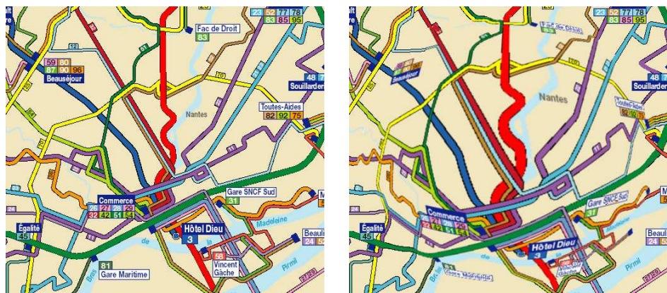
FIG. 4.9 – Exemple de distorsion fish eye
