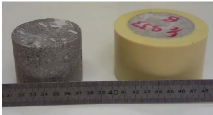
Figure II.4. Échantillon pour la mesure de la perméabilité au gaz
