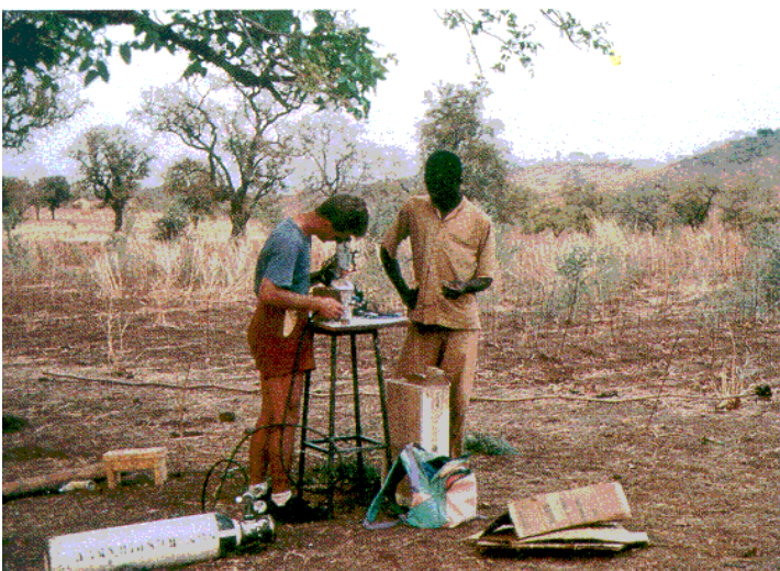
Mesure des tensions de sève sur un champ de drageons de Faidherbia albida (site des drageons) à l'aide d'une chambre à pression portable de (Dossi, mars 1995).
