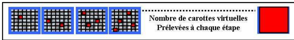
Figure 3.7 : Principe du prélèvement aléatoire des carottes virtuelles.
