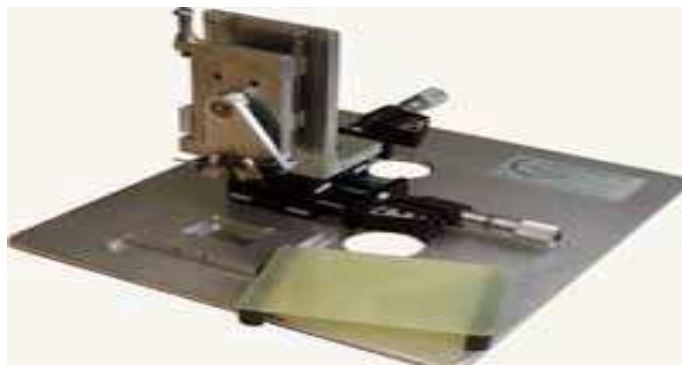
Figure 2.3 : Le TMA Micro Arrayer (Beecher Instruments™) : instrument pour réaliser des blocs TMA.
