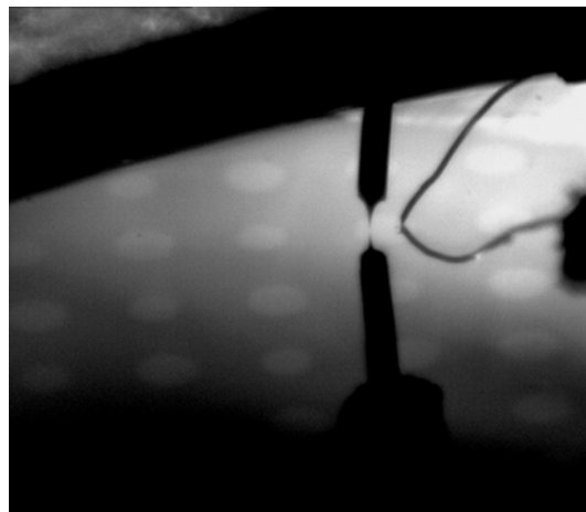
Figure 14: Cliché pris depuis la caméra montrant les contacts du fil d'Or et de la pointe STM sur un plot métallique d'Or, d'épaisseur 5\ \text{nm} , sur un substrat de \text{GaAs}(001) . Les réflexions de la pointe et du fil à la surface de l'échantillon permettent une approche précise.
