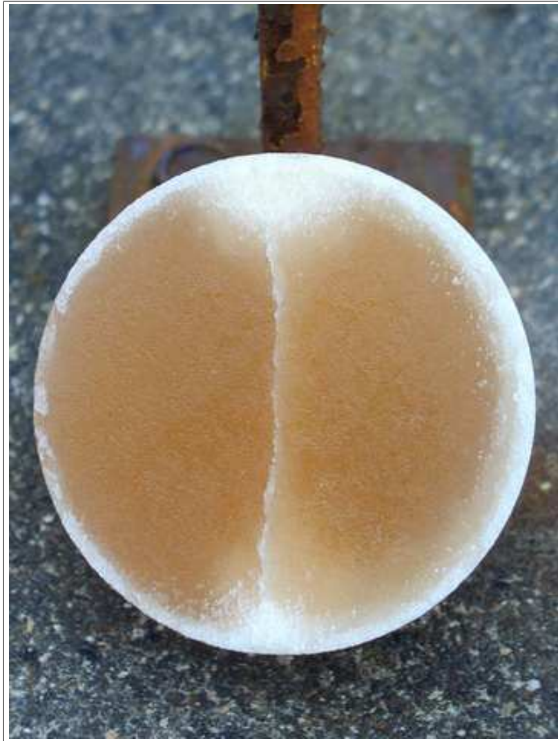
FIG. 1 – Photographie d'une éprouvette de sel après un essai brésilien
