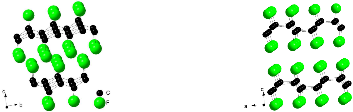
FIG. 3.4: Deux composés covalents du graphite contenant du fluor (en vert) et synthétisés à haute température d'après N. Watanabe [41]. A gauche, le composé a une conformation chaise tandis qu'à droite, il a une conformation bateau. Il existe d'autres types de structures cristallines pour ces composés fluorés dépendant du processus de synthèse.
