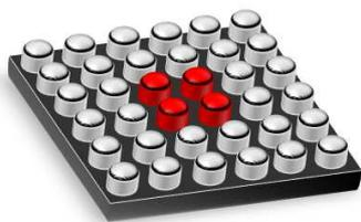
*Fig. 95. Pattern de stimulation indiquant la position entre l'axe et les frontières de la zone de tolérance par modulation de la fréquence.*
