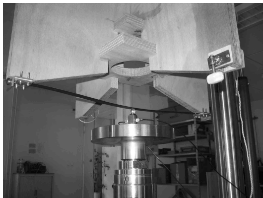
Fig. 4.6: Maquette de la table d'harmonie du piano et machine MTS
