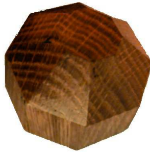
Fig. 1.1: éprouvette à 13 faces
