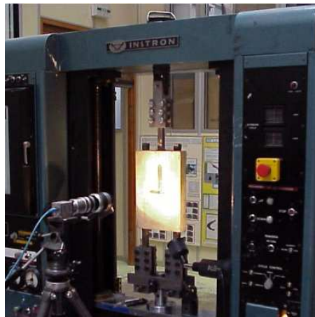
Fig. 1.10: Essai d'arrachement sur barres corrodées.
