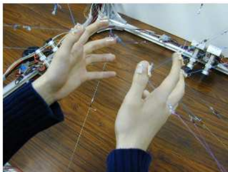
FIGURE 4.22 – Le SPIDAR (Space Interface Device for Artificial Reality) se compose de câble et de moteurs les retenant. Ce dispositif permet la gestion des deux mains et de quatre doigts.
