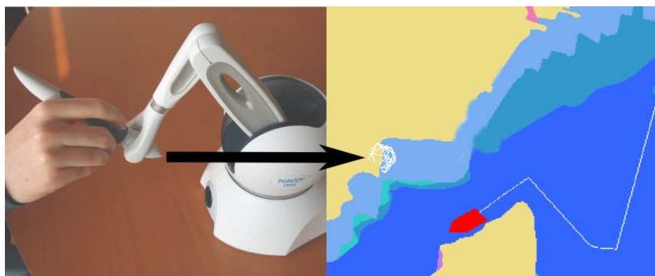
FIGURE 5.1 – Le Phantom Omni (à gauche) et l'environnement virtuel maritime de SEATOUCH (à droite). La pointe du stylet du Phantom dans l'espace réel dirige le curseur représenté par la sphère blanche au contact de la côte virtuelle.
