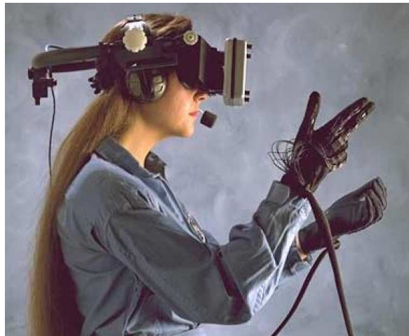
Fig. 1.9 - Système de réalité virtuelle utilisant un HMD et des gants haptiques.
