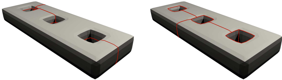
(a) Découpage topologique par l'algorithme 3.2 en utilisant la distance euclidienne. (b) Découpage topologique par l'algorithme 3.2 en utilisant une distance tenant compte de la courbure ( c = 0,4 ).
