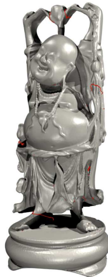
FIG. 3.5 – Découpage d'une surface de genre 104, sans bord et composée de 543 652 triangles à l'aide de l'algorithme de recherche approximative du plus court lacet non séparant. Maillage 3D original fourni par le dépôt de formes laboratoire Computer Graphics de l'Université de Stanford.
