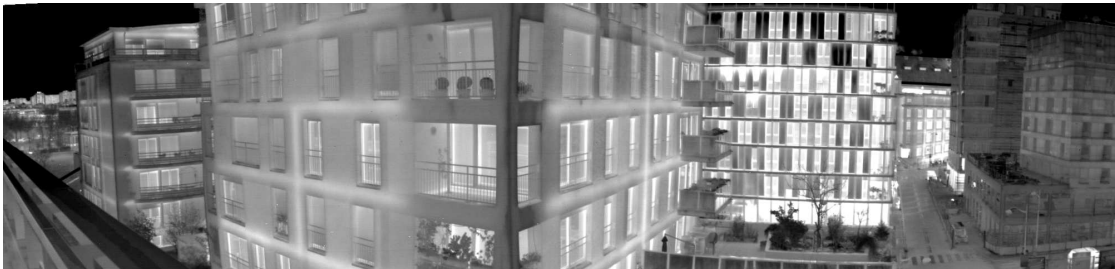
FIG. 1.4 – Image panoramique d’une résidence en infrarouge ( 8\mu m ).
