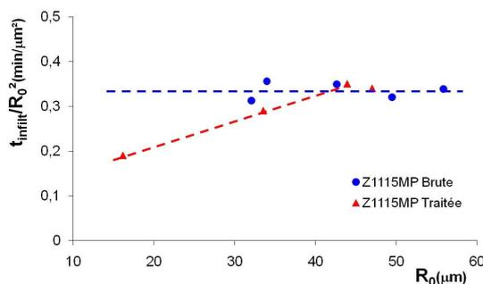
Figure 12 : Temps d'infiltration, déterminé à partir des cinétiques d'infiltration du SBR dans la silice tracées selon le modèle de Bohin, normalisé par le rayon de l'agglomérat au carré représenté en fonction du rayon de l'agglomérat. Figure extraite de [Rou 08].
