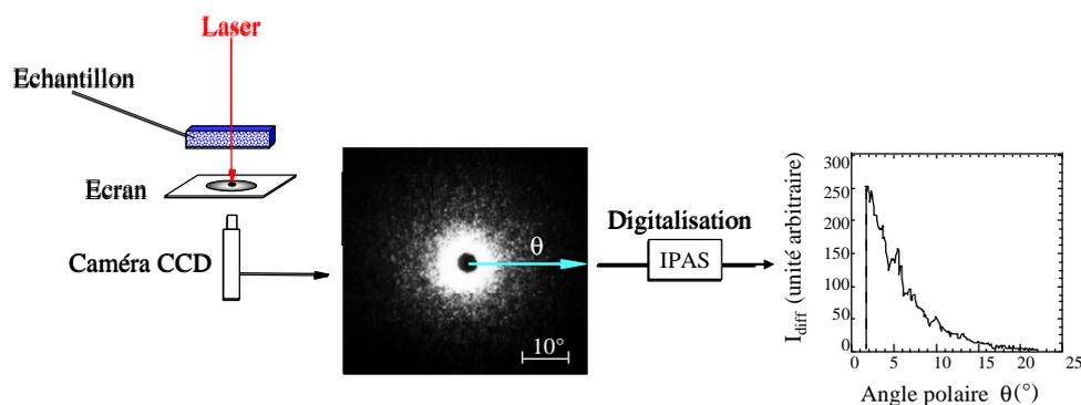
Figure 2 : Illustration d'un essai de diffusion de la lumière avec extraction d'un profil d'intensité en fonction de l'angle polaire à partir du cliché de diffusion à l'aide du logiciel IPAS.
