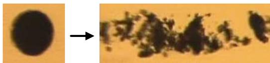
Figure 17 : Illustration du mécanisme de désintégration pour un agglomérat de silice Z1115MP dans du SBR.  $R_0=37 \mu\text{m}$ ,  $\dot{\gamma}=56 \text{ s}^{-1}$  Photos extraites du travail de [Rou 08].
