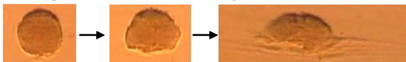
Figure 18 : Illustration du mécanisme de dislocation pour un agglomérat de silice Z1115MP complètement infiltré dans du SBR sous l'action d'un cisaillement.  $R_0=35 \mu\text{m}$ . Photos extraites du travail de [Rou 08]
