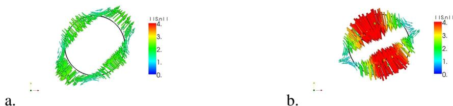
Figure 13 : Contraintes normales exercées autour d'une particule (calcul 2D) en suspension dans une matrice liquide soumise à un champ de cisaillement : a. Les contraintes sont visualisées sous forme de flèches. Représentation dans le plan écoulement/vorticité. Figure extraite de [Lau 08].
