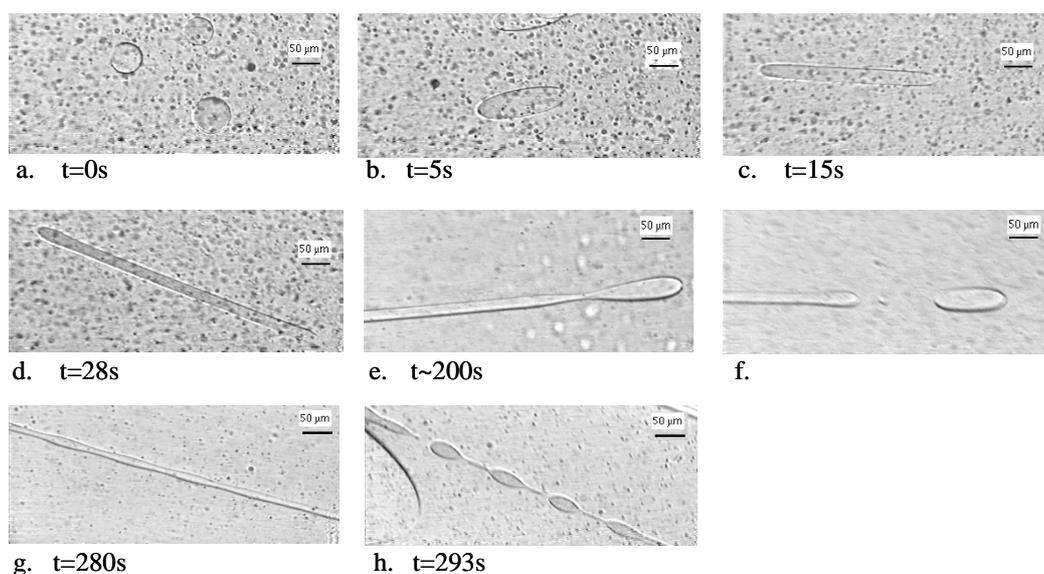
Figure 5 : Déformation instationnaire d'une goutte de solution aqueuse d'HPC dans une matrice PDMS soumise à un taux de cisaillement constant<sup>1</sup>. Les photos a. à d. montrent l'étape de déformation, e. et f. le mécanisme de pincement des extrémités, g. et h. la fragmentation du filament suite au développement d'instabilités capillaires. Photos extraites de [Tsa 95].
