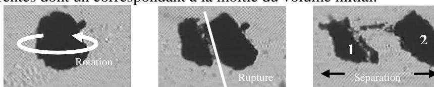
Figure 14 : Séquence de rupture d'un agglomérat N234 dans du SBR.  $R_0 = 70\mu\text{m}$ ,  $\dot{\gamma} = 3\text{ s}^{-1}$ . Mécanisme observé dans le plan écoulement/vorticité. Figure extraite de [Col 04].
