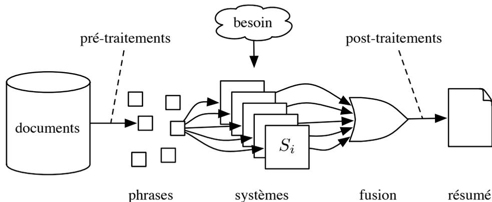
**FIG. 6.1:** Schéma de fonctionnement du système LIA-Thales pour DUC 2006. Les documents sont découpés en phrases après application de pré-traitements. Puis différents systèmes établissent des listes de priorité d'inclusion des phrases dans le résumé. Les listes sont fusionnées pour trouver une sélection optimale de phrases. Des post-traitements améliorent la forme du résumé final.
